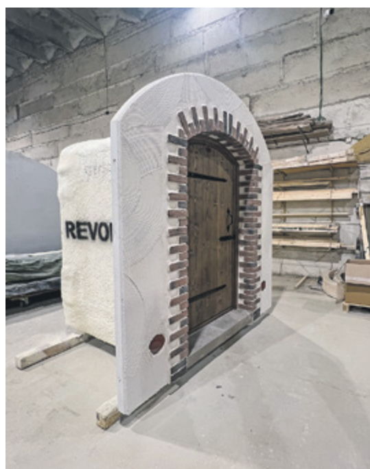
Nii valmib Revonia tootmishoones järjekordne keldri moodul, kokku tõstetakse need ühe päevaga. Fotod: Merike Pinn ja Revonia
